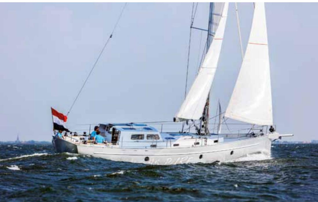
Besegelt ist die neue Bestevaer von KM Yacht-builders im Standard mit einem 58 Quadratmeter messenden Großsegel und einer 45 Quadratmeter-Genua.
